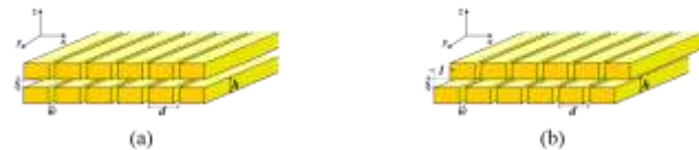
図1 積層メタルスリットアレイ構造 (a: l = 0 , b: l = d/2 )
